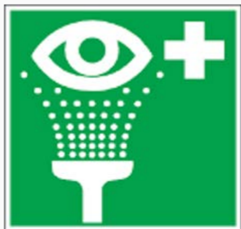
Hình 19 Biển báo trạm rửa mắt
