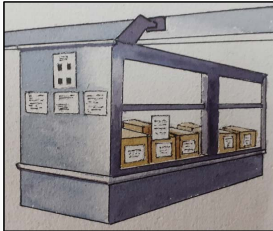
Hình 12 Hệ thống thông gió của máy hút khói để bảo quản thuốc nhuộm
