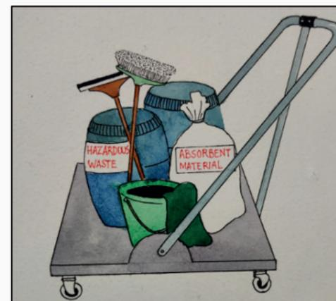
图17：泄漏控制工具包
